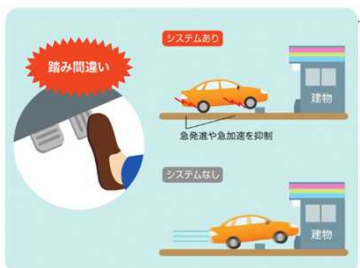
ペダル踏み間違い急発進抑制装置
