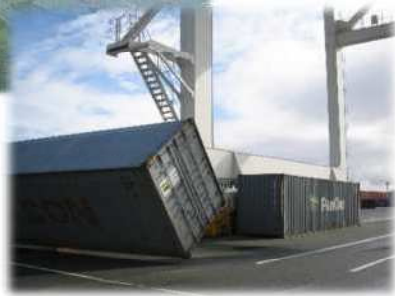
横転するコンテナ（神野地区）
