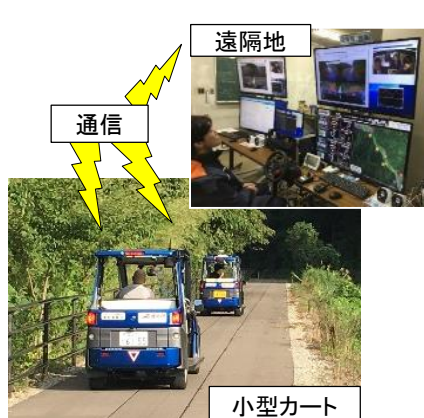
1対2の遠隔監視・操作(永平寺町)
