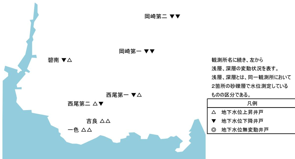
図2-7 西三河観測井の地下水位変動状況(平成23年と24年の平均地下水位比較)
