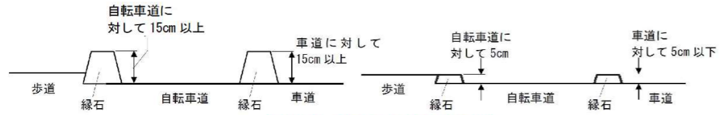
図 12.1 自転車道の分離構造の例
