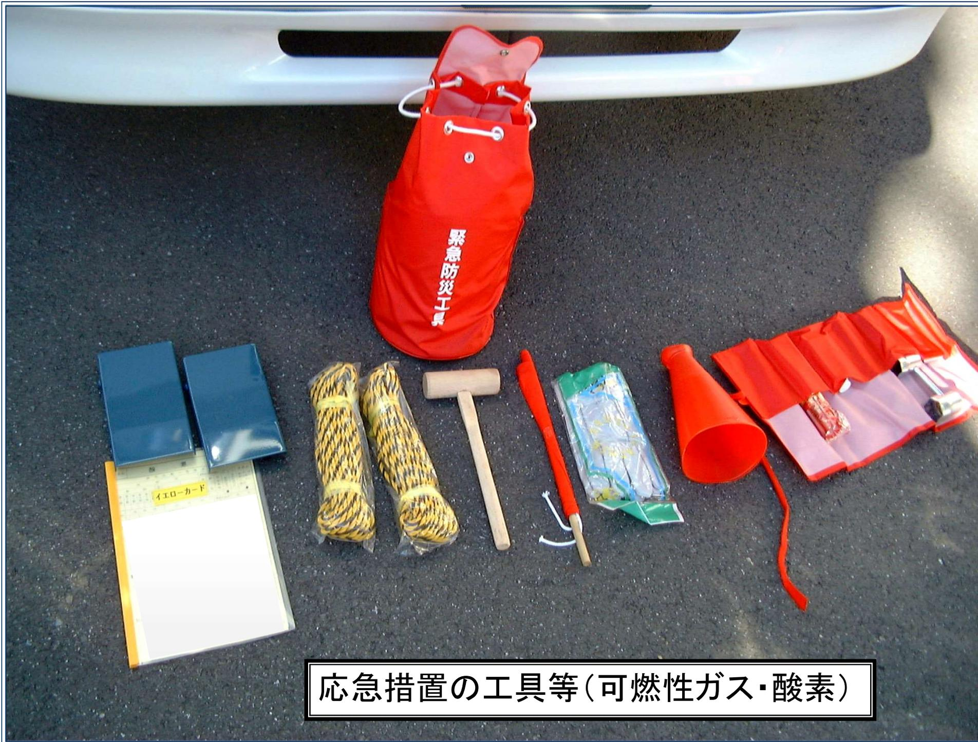
応急措置の工具等(可燃性ガス・酸素)
