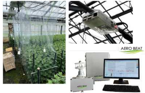
左：光合成チャンバー、右上：定点カメラ 右下：統合環境制御装置
