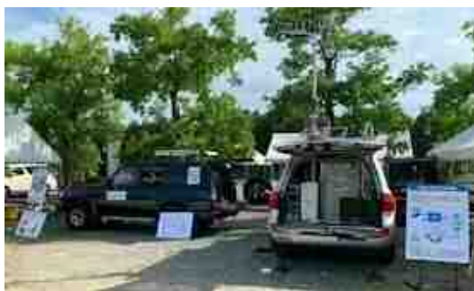
【電源車から送信車両への給電】
