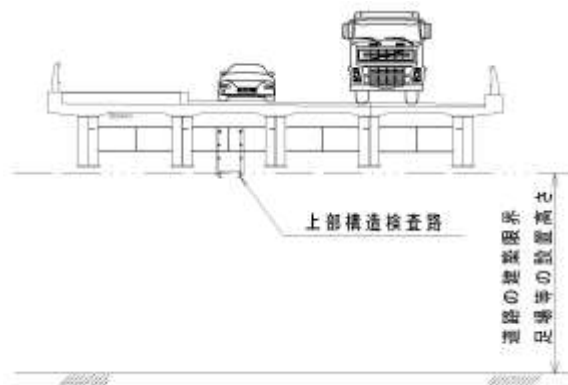
図 10.1.11 桁下の建築限界と検査路（建築限界を侵している例）
