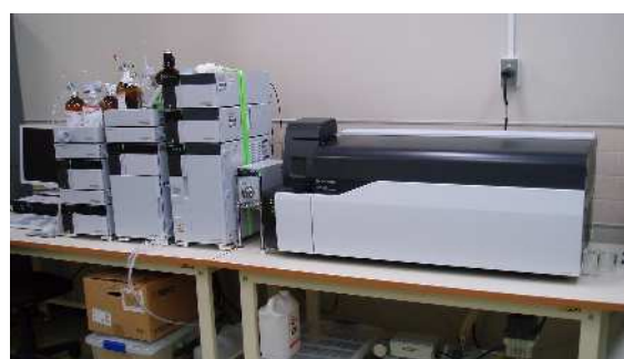
液体クロマトグラフ質量分析計 (微量有機物質の測定)
