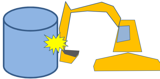
工事中に破損
