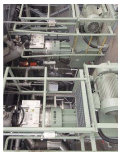
③造粒機 (押出成型式) 粉塵抑制のため乾燥汚泥を約5～6mm、長さ約10～15mmに成型します。
