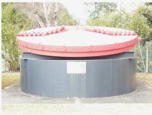
名港導水路海底トンネルシールド機械のカッター盤
