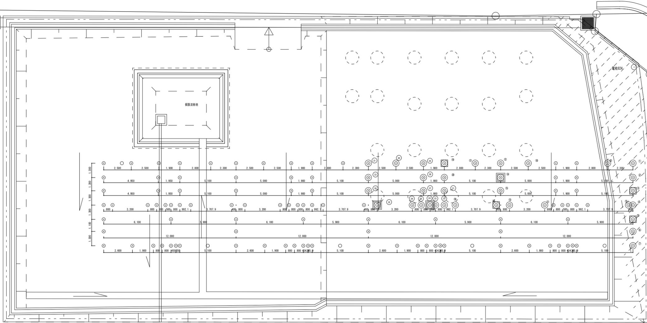
※: (虚線) は集会所基礎下柱状改良φ1200(将来工事)の施工予定位置を示す。
