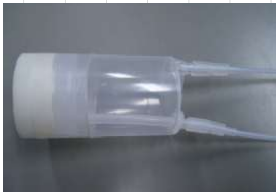
指よりの皮膚ガス採取プローブ
