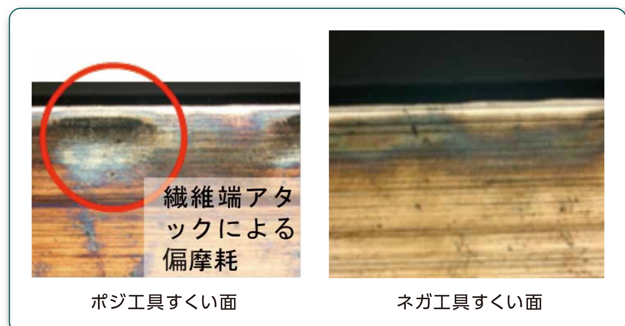
図2 工具すくい角による工具すくい面摩耗の相違
