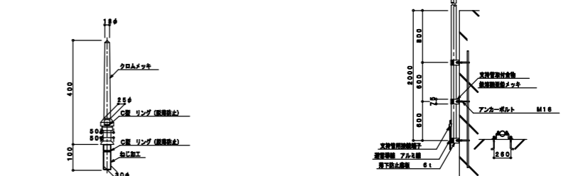
避雷針 JIS 中径 (鋼製) S=1/10
