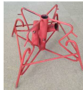
開発したくくり罠補助具「からまる棒」杭を3本打って使用する
