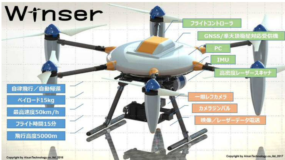
開発した実証実験用UAVおよびレーザーユニット
