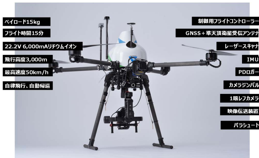
開発した実証実験用UAV（カメラ+レーザースキャナ搭載） 開発元：プロドローン
