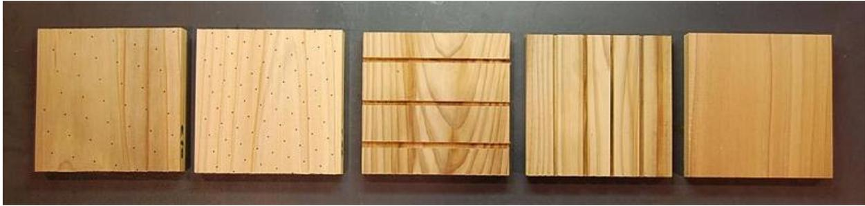
穿孔 4000 個/m<sup>2</sup> 穿孔 8000 個/m<sup>2</sup> 横溝加工 縦溝加工 無処理
