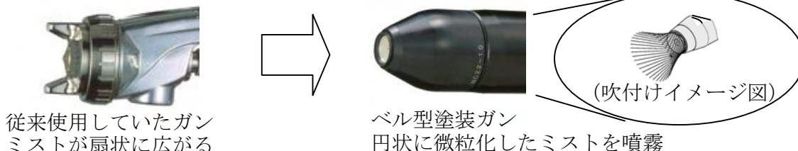
図.4 従来のガンとベル型塗装ガンの比較
