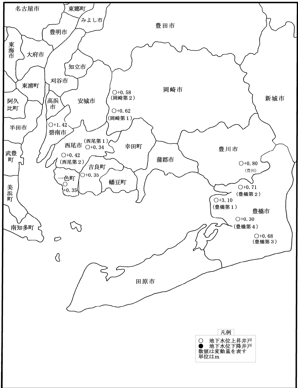
図-16 深層の地下水位変動状況 (12井) (平成20年と21年の平均地下水位比較)
