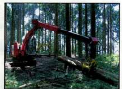
ロングアームグラブによる作業
