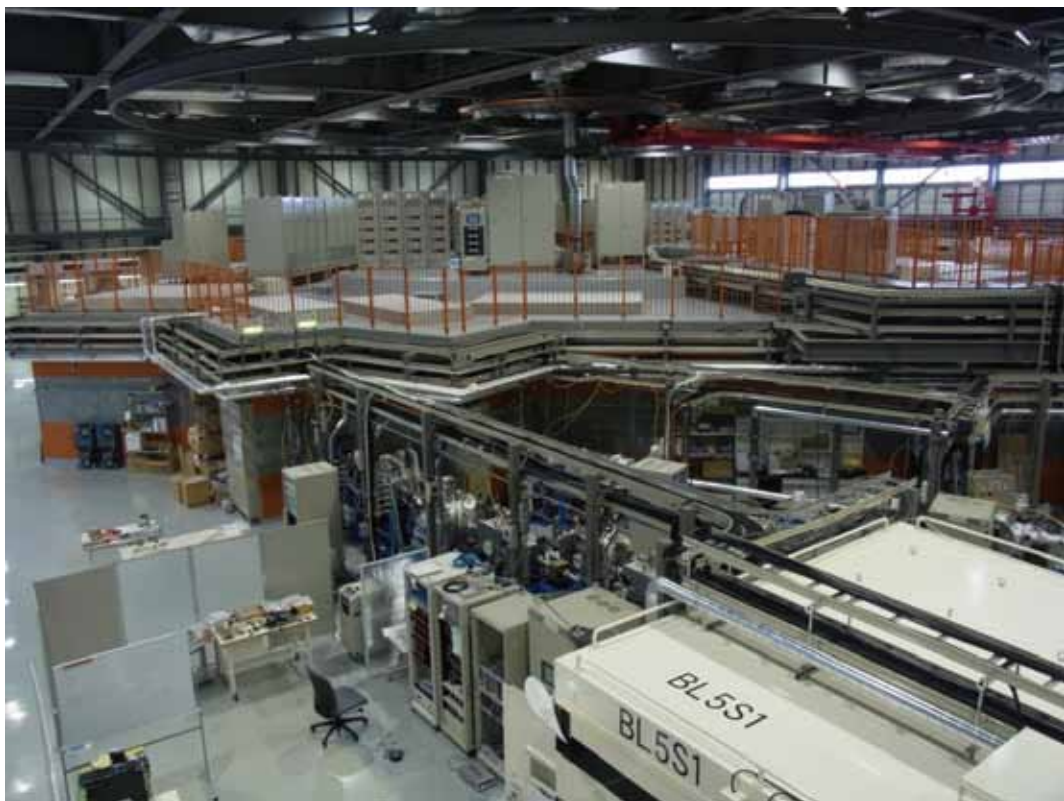
写真3 あいちシンクロトン光センターの内部 (星形の囲いの中に、シンクロトン・ブースター（蓄積リング等）がある。 手前の白い箱「BL5S1」が測定ブース。)
