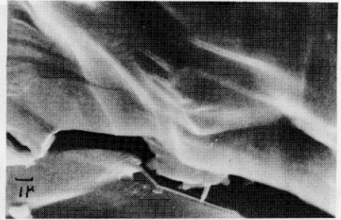
写真9 磁器素地(1200℃焼成) 7000倍
